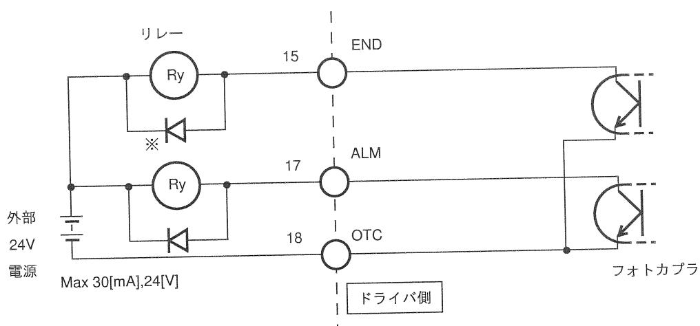
最大開閉電圧 24 [V] 最大負荷電流 30 [mA]
